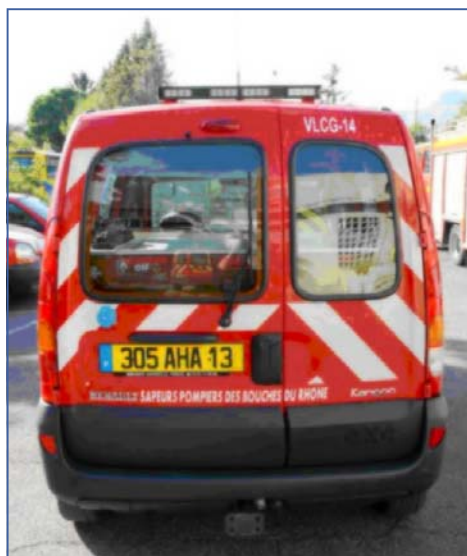
Sérigraphie et signalisation arrière avec une rampe à LED
